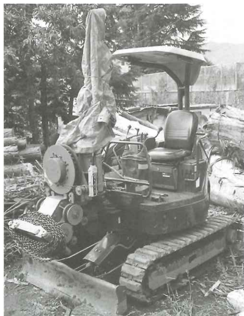
チェーン集材の要、巻取装置取付けた移動車
